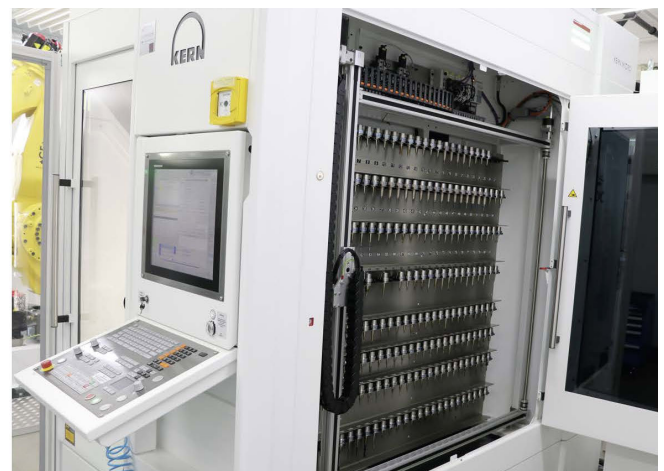
Polymechniker Sascha Hämmerli muss an der vollautomatisierten Kern Micro HD nur wenige Befehle eingeben, schon produziert das 5-Achs-BAZ mannlos fehlerfreie Bauteile in Serie – Elektroden aus Grafit oder Kupfer ebenso wie Hartmetallkerne und noch mehr
