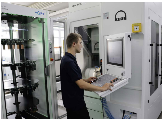
Polymechniker Sascha Hämmerli muss an der vollautomatisierten Kern Micro HD nur wenige Befehle eingeben, schon produziert das 5-Achs-BAZ mannlos fehlerfreie Bauteile in Serie – Elektroden aus Grafit oder Kupfer ebenso wie Hartmetallkerne und noch mehr
